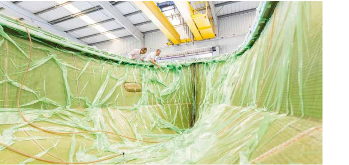
La técnica del proceso de infusión de resina utilizada por Sasga Yachts para el modelado del casco, da lugar a un casco fuerte, ligero y con una fibra de vidrio perfectamente laminada, obteniendo la máxima fuerza y eficacia.
